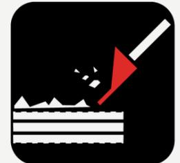
Después de desencofrar limpiar la cara encofrante con agua y un rascador.
