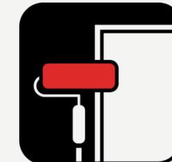
Antes de hormigonar aplicar una capa de desencofrante. Después de hormigonar limpiar la cara nerviada.
