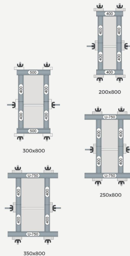
Además, estas combinaciones entre paneles permite adaptarse a las necesidades y secciones de cada proyecto con soluciones especiales como pilares en medianera (a 3 caras) o pilares en junta.
