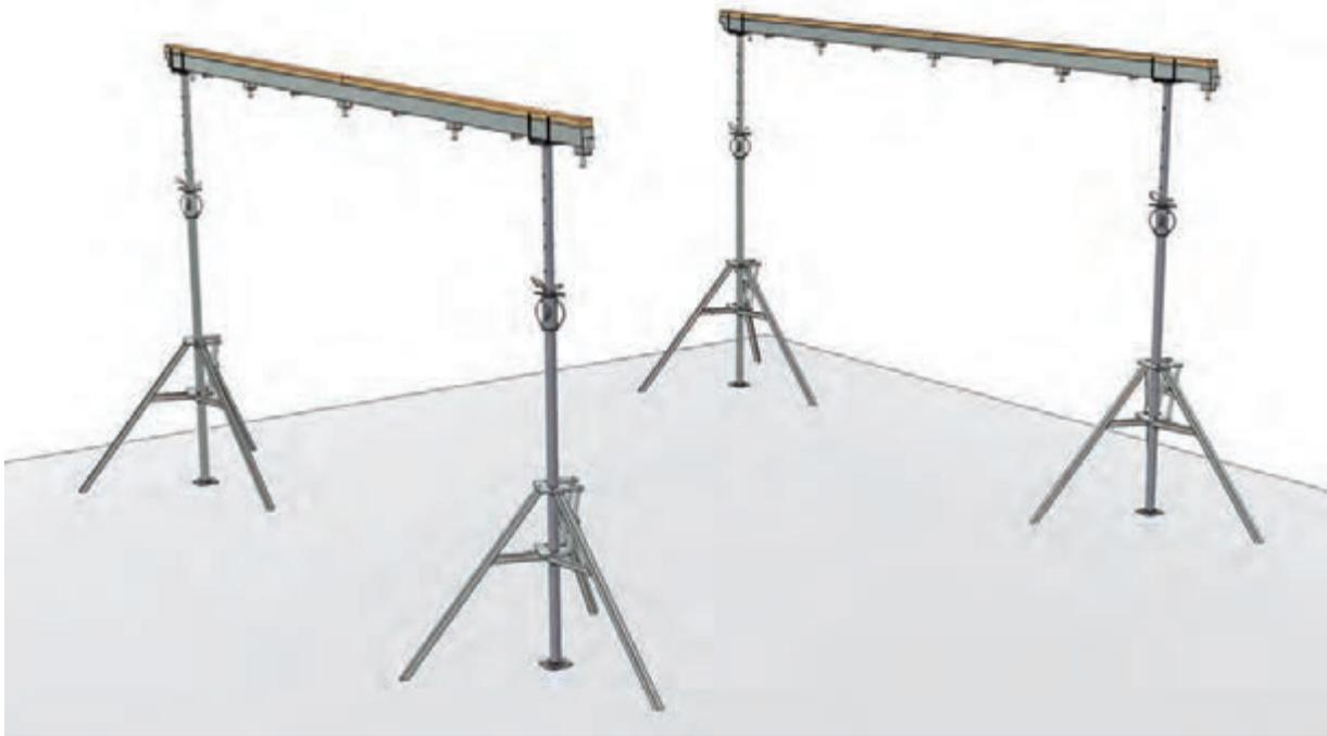
1. Instalación de las vigas mixtas principales y nivelación de las mismas
