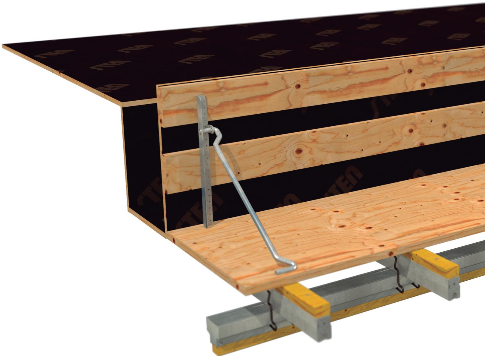
Seguridad perimetral completa antes, durante y después del hormigonado.
